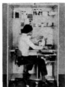
Фотолаборатория-кабина (журнал «Ильфорд-контраст»): а — с закрытыми шторами; б — компоновка кабинной
